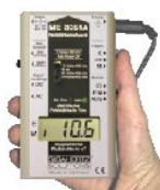
... branchez le connecteur jack du câble de terre fourni dans la prise marqué  $\perp$ , et faire passer le câble derrière le boîtier. Attention : Ni le câble de terre ni les doigts doivent se trouver devant le bord avant de l'appareil (les valeurs de mesure seront faussées!).
