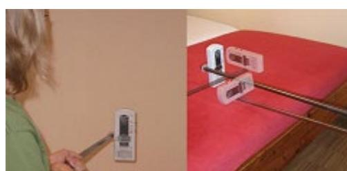
port non conductrice (comme par ex. le PM5 de Gigahertz Solutions). De plus, on doit faire trois mesures dans tous les trois axes XYZ (voir photo), et ensuite additionner les résultats vectoriellement<sup>3</sup>. Sur
