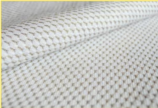
\* zur großflächigen Abschirmung hochfrequenter elektromagnetischer Wellen
