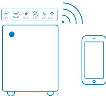
Oczyszczacz powietrza może też być poddany automatycznej regulacji w zależności od odczytów dotyczących jakości powietrza wbudowanych czujników (280i) lub opcjonalnego monitora jakości powietrza na zewnątrz Blueair Aware™ (205).
