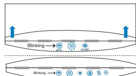
Klappen Sie den Deckel hoch und drücken Sie den Berührungsschalter für die Luftdurchsatzgeschwindigkeit. Wenn das WLAN-Symbol blinkt, kann der Luftreiniger mit der mobilen App Blueair Friend gekoppelt werden.
