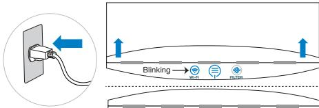
Soulevez le cache rabattable et appuyez sur la touche de réglage du débit d'air. Lorsque le symbole indiquant le wi-fi commence à clignoter, le purificateur d'air est prêt à être apparié avec l'application mobile Blueair Friend.
